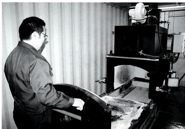
点火口をはじめ全体を隠さずに設置した火葬炉
